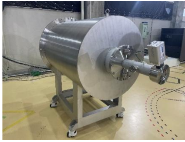
(a) 上流側真空槽と圧力制御付きバタフライバルブ (b) 上流側真空槽内部(縮流胴側) バルブ(大気吸い込み側)
